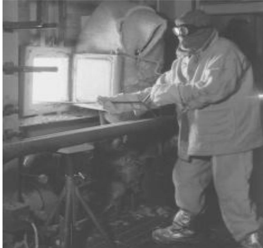
Técnico de control de calidad tomando muestras de vidrio del horno y usando equipo de protección personal contra el calor y gafas antirrayos I.R.
